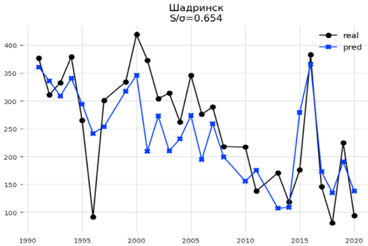
Рис. 6. Сопоставление фактического и предсказанного максимальных уровней на примере Шадринска, “real” – фактический, “pred” – предсказанный. Рассматриваемый горизонт прогноза составляет 90 временных шагов (суток) и отсчитывается с 15 марта каждого года, внутри которого выбираются максимумы среди фактических и предсказанных значений. По оси абсцисс – рассматриваемый год, по оси ординат – уровень воды (в см.)
