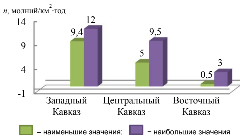
Рис. 2. Поражаемость Северного Кавказа наземными молниями.
