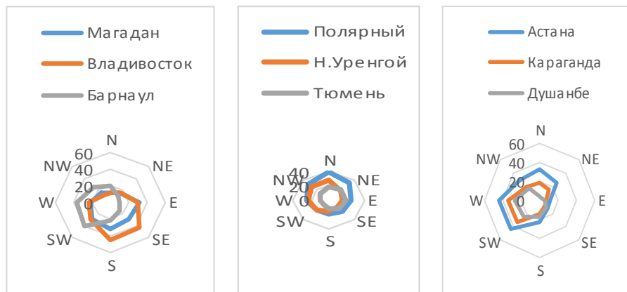
Рис. 4. Среднегодовые розы ветров (повторяемость, %) при наличии облаков с ВНГО \leq 1500 м и при их количестве \geq 5 окт на некоторых аэродромах азиатской части России и ближнего зарубежья за период 2001–2018 гг.
