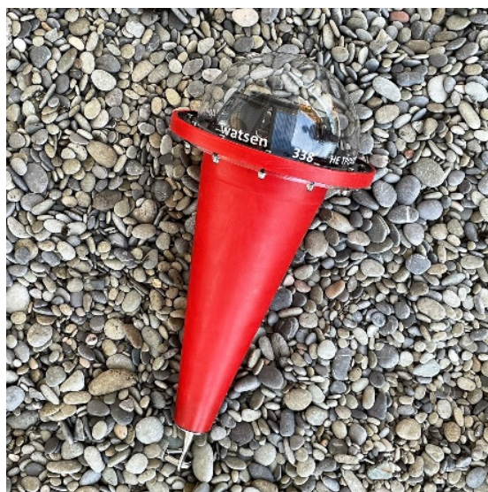
Рис. 2. Датчик температуры воды проекта WatSen. Fig. 2. WatSen water temperature sensor.
