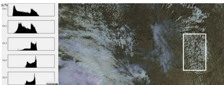
Рис. 2. Спектральные яркости в градациях фототона и вид со спутника слоисто-кучевой (закрытые ячейки), кучевой и мощно-кучевой облачности (открытые ячейки).
