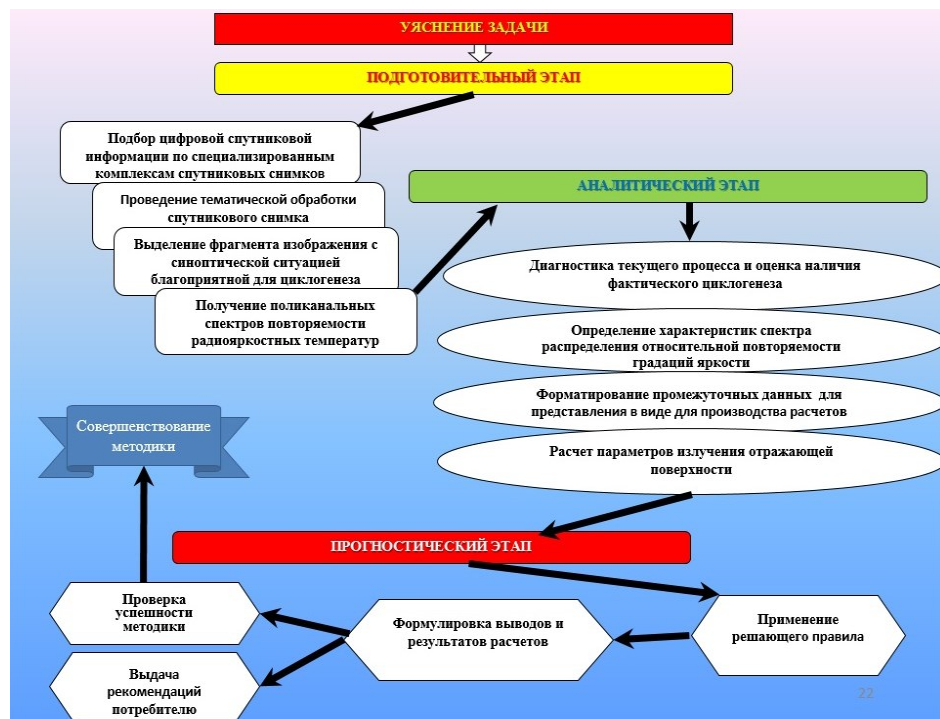
Рис. 10. Схема методики прогноза циклогенеза по спутниковыми данным.
