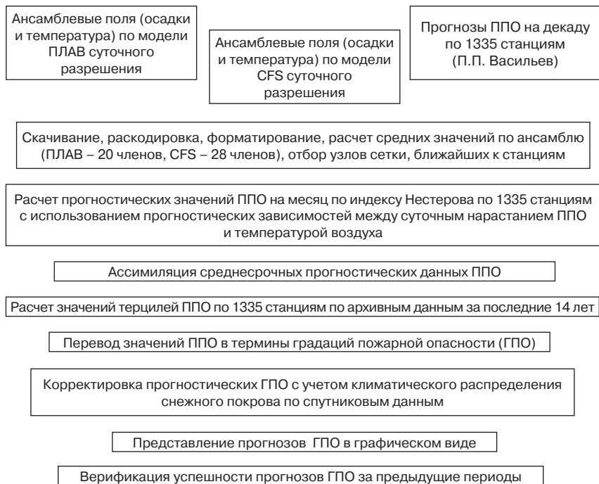
Рис. 1. Блок-схема технологической линии выпуска прогнозов ППО на месяц.
